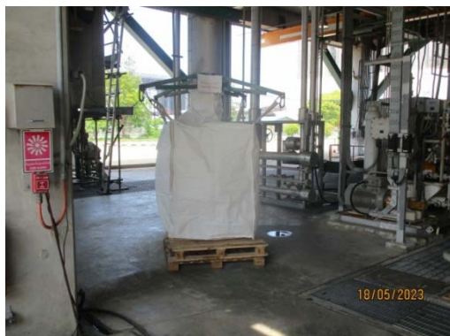
รูปที่ 28 ถุงบรรจุเศษพลาสติกขนาดเล็ก ที่ปะปนมากับน้ำเสียจากการตัดเม็ด
